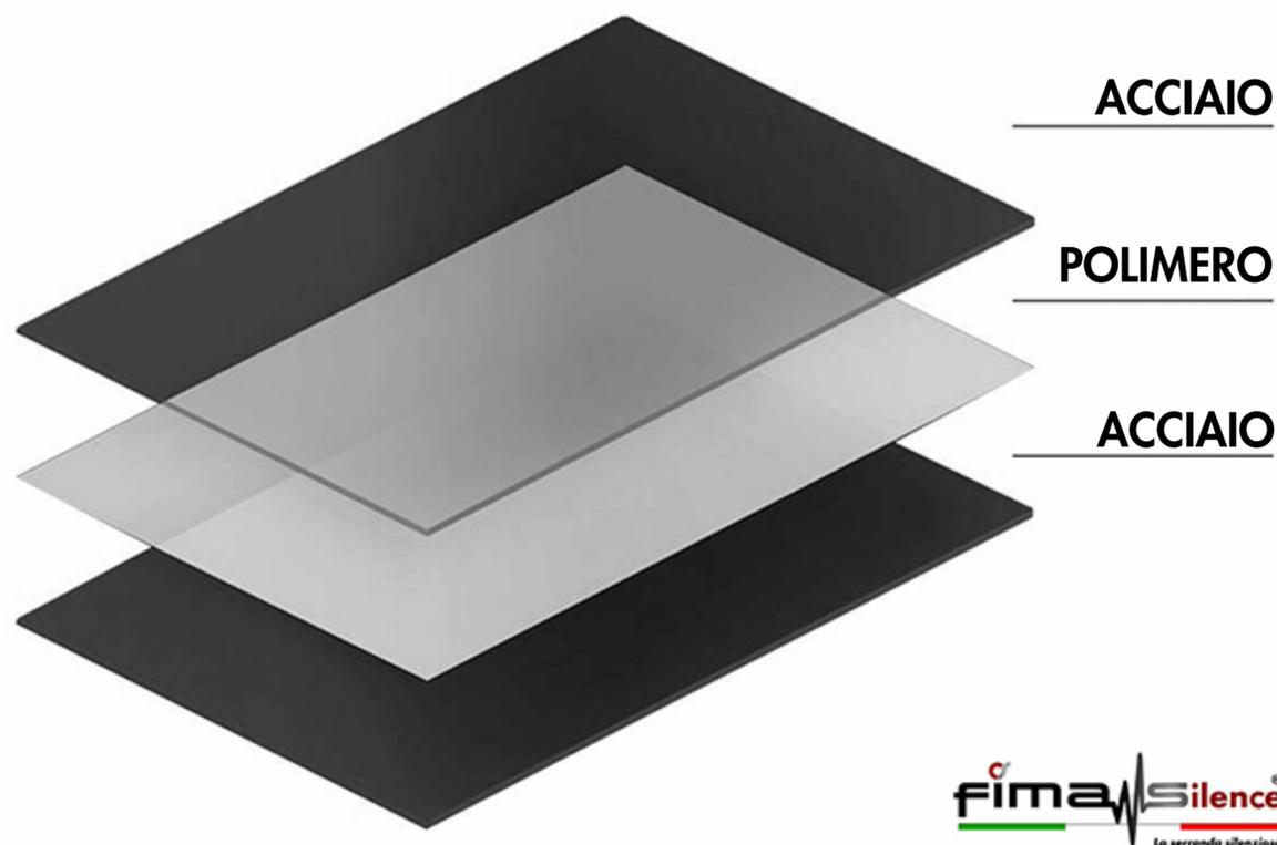
Due lamine di acciaio vengono accoppiate mediante un polimero biadesivo, che consente di abbattere il suono. Un sistema ben lontano da quello delle tradizionali serrande avvolgibili, che si affidano solo a delle guarnizioni.
